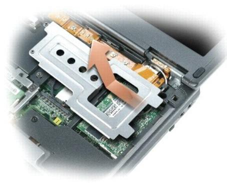
4. Si no hay instalada una minitarjeta PCI, vaya al [paso 5](#). Si está sustituyendo una minitarjeta PCI, retire la tarjeta existente.
