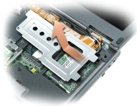
6. Desconecte los cables de antena de la minitarjeta PCI y desenrolle los cables para apartarlos de la base del ordenador.
