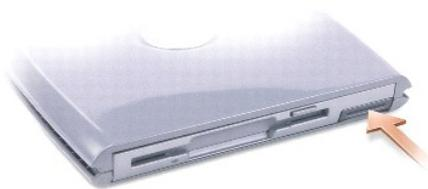
2. Tire del dispositivo sujetando el seguro de liberación para extraer el dispositivo del D/Bay.
