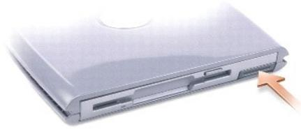
4. Tire del dispositivo sujetando el seguro de liberación para extraer el dispositivo del D/Bay.
