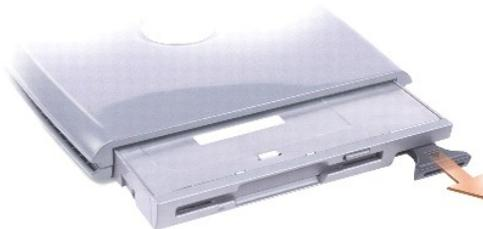
3. Inserte el nuevo dispositivo en el compartimento, empuje el dispositivo hasta que oiga un clic y presione el pasador de liberación del dispositivo para que quede alineado con el compartimento.
