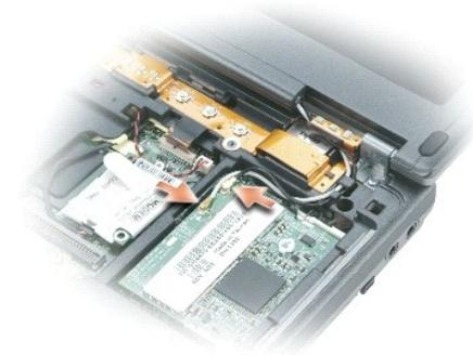
7. Tire de la lengüeta para desconectar el cable de la pantalla de la placa base.
