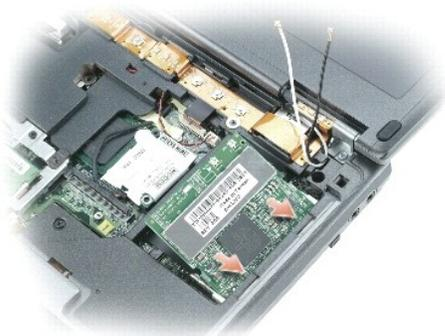
➡ **AVISO:** Para no dañar la tarjeta Mini PCI, no coloque nunca cables encima ni debajo de la tarjeta.
