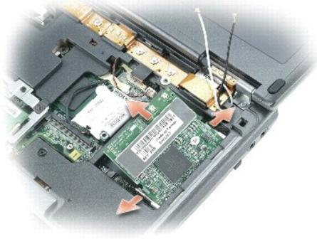
c. Extraiga la minitarjeta PCI de su conector.
